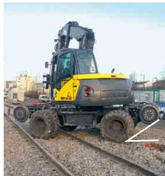
Les angles de franchissement avant et arrière d'un minimum de 30° facilitent l'entrée en voie quelque soit l'obstacle (talus par exemple).
