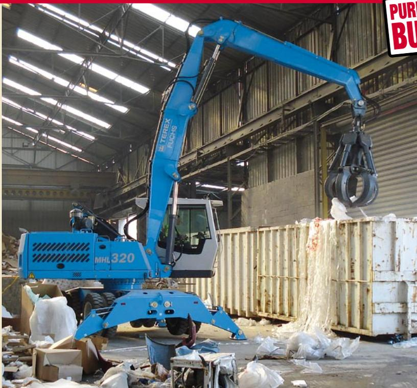
Faible encombrement, maniabilité, puissance : tels sont les atouts de la pelle industrielle MHL320 D. Combinant portée de 10,4 m et poids de service de 19 tonnes, cette machine s'avère être la solution idéale pour tous ceux qui ne veulent rien laisser au hasard entre puissance, performances et fiabilité, même sur les machines d'entrée de gamme.
